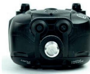
Lorsque la sortie IQ ou Smart LED ne sont pas utilisées, les supports de douilles en caoutchouc doivent être enfoncés dans les sorties. Lorsqu'ils ne sont pas nécessaires, ils doivent être enfoncés dans les supports jacks sous le détecteur.
