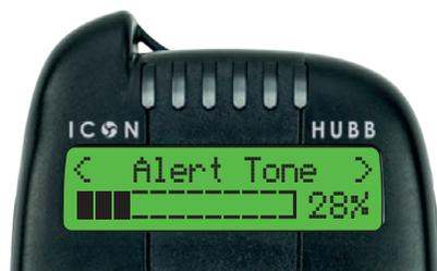
Dans le "menu avancé" aller aller dans "tonalité alerte" pour ajuster la tonalité des alertes du détecteur.
