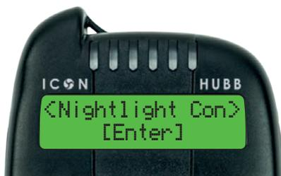
Nel "Menu avanzato" vai "Configurazione luce notturna". Trova la prima opzione intitolata "Luminosità luce notturna" e regola l'impostazione manuale.
