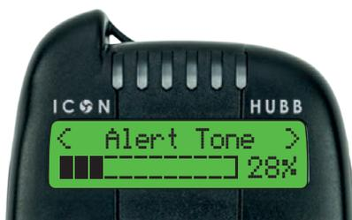
Nel "Menu avanzato" vai su "Tono di avviso" per regolare il tono dell'allarme e dell'HUBB.
