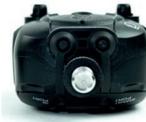
Quando la porta IQ o la porta Smart LED non vengono utilizzate, i supporti delle prese in gomma devono essere premuti nelle porte. Quando non sono necessari, devono essere premuti nei supporti delle prese sul retro dell'allarme.
