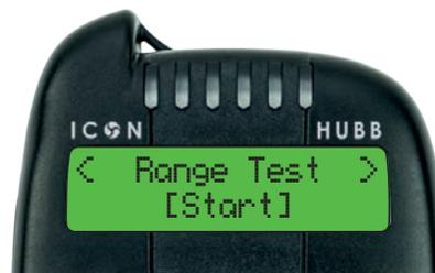
Passare all'opzione "Range Test" e utilizzare il pulsante OK per iniziare il test. Quando viene stabilita una connessione, l'HUBB riporterà la potenza del segnale dell'allarme connesso e indicherà anche che il LED sta funzionando.
