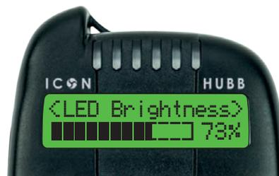
Andare a "Luminosità LED" per modificare la luminosità dei LED visualizzati sull'allarme.
