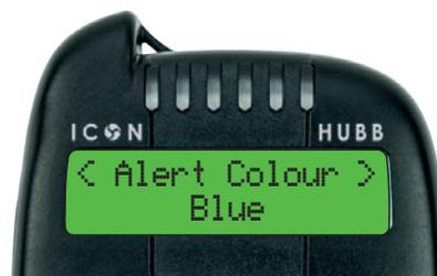
Andare su "Colore avviso" per modificare il colore utilizzato per visualizzare gli avvisi sull'allarme abboccata e sull'HUBB.
