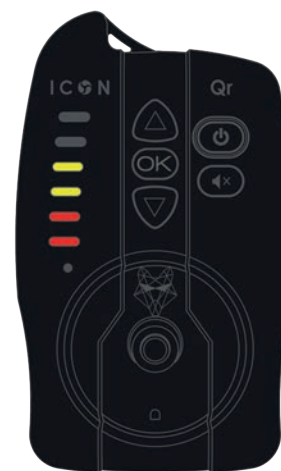
Niveau batterie bon
