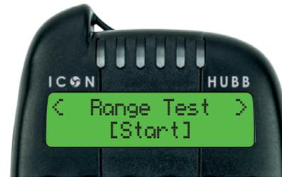
Navigiere zur Option "Reichweiten-Test" und starte den Test mit der Taste "OK". Wenn eine Verbindung hergestellt wird, meldet der HUBB die Signalstärke des angeschlossenen Bissanzeigers und zeigt auch an, dass die LED funktioniert.
