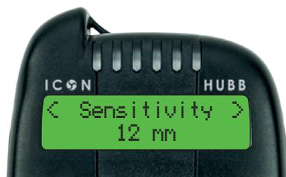
8 Empfindlichkeitsstufen, erweiterbar auf 16 über HUBB Link 2 mm, 6 mm, 12 mm, 18 mm, 25 mm, 35 mm, 60 mm oder 100 mm. Zusätzliche Empfindlichkeitsstufen 4 mm, 8 mm, 16 mm, 20 mm, 30 mm, 40 mm, 80 mm oder 300 mm.
