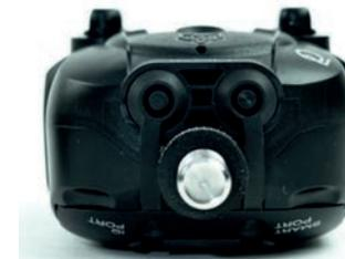
Wenn der IQ-Anschluss oder der Smart LED-Anschluss nicht verwendet werden, sollten die Gummibuchsenhalter in die Anschlüsse gedrückt werden.
