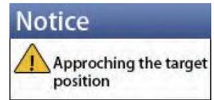
Le rayon d'alarme par défaut est de 5 mètres. Cela signifie que lorsque le bateau est à une distance inférieure ou égale à 5 mètres du waypoint, l'alarme du sondeur retentira.
