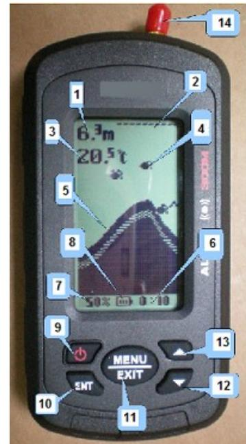
*L'écran montre un graphe des mesures successives des mesures de profondeur qu'il a enregistré. Le graphe défile de la gauche vers la droite, la dernière valeur est celle située le plus à gauche.*
