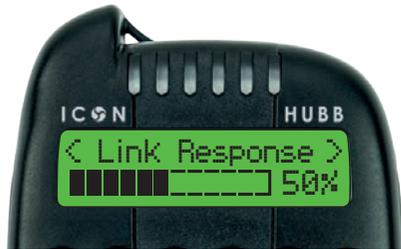
Ajuste le temps de réponse de tous les appareils connectés. Le système électronique détecte quand les appareils sont connectés, à utiliser quand vous voulez être sûrs de vous situer dans le périmètre du signal des appareils. Cela se fait manuellement.
