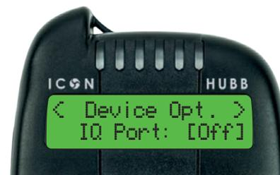
Un accessoire IQ connecté à la sortie Alarm IQ peut être activé / désactivé avec le HUBB.
