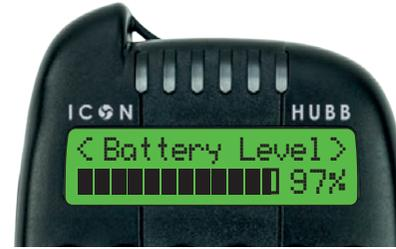
Indique précisément le niveau de batterie du récepteur. Durée d'environ 500 heures en veille.
