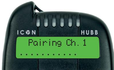
Quand un appareil est détecté il s'affichera. Si le couplage n'est pas effectué, le récepteur revient à l'étape précédente pour une autre tentative.
