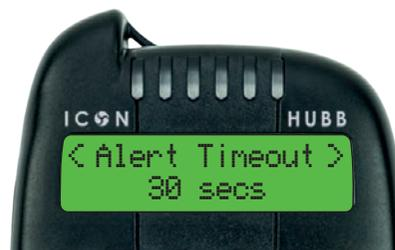
Aller dans "delais alerte" pour ajuster le temps de fonctionnement de la LED sur le détecteur. 60Secondes / 30 secondes / 20 secondes / 10 secondes / 5 secondes.
