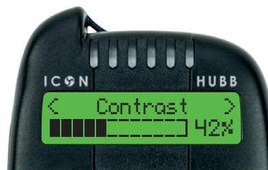
Ajuste le contraste de l'écran. Utiliser les touches gauche et droite pour ajuster le contraste de l'écran.
