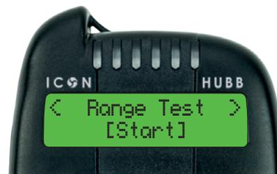
Naviguez jusqu'à l'option «Test de portée» et utilisez le bouton OK pour commencer le test. Lorsqu'une connexion est établie, le récepteur signale la force du signal du détecteur connecté et indique également que la LED fonctionne.
