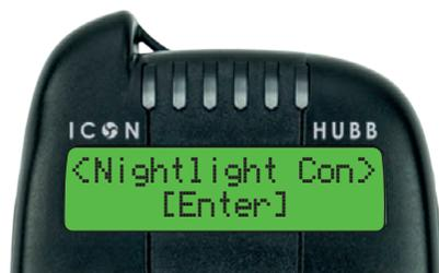
Dans "menu avancé" aller dans "veilleuse de nuit" Trouvez la première option intitulée " Luminosité de la veilleuse " et ajuster le réglage manuellement.
