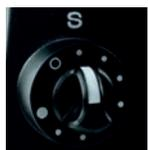
Le bouton de sensibilité ajuste la quantité de course de ligne avant qu'une alerte ne soit déclenchée. Il existe également une position d'arrêt pour désactiver le détecteur. 8 niveaux de sensibilité, extensibles à 16 via le récepteur. 2 mm, 6 mm, 12 mm, 18 mm, 25 mm, 35 mm, 60 mm, 100 mm. \* Paramètres de détection supplémentaires 4 mm, 8 mm, 16 mm, 20 mm, 30 mm, 40 mm, 80 mm et 300 mm.
