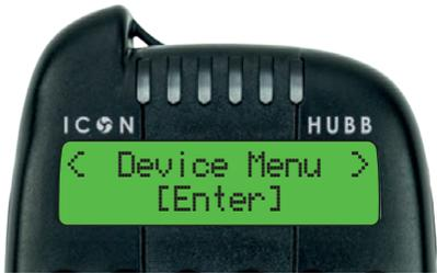
All'attivazione dell'allarme abboccata il tono dovrebbe essere replicato sull'HUBB e i LED dell'HUBB dovrebbero replicare il colore di avviso mostrato sull'allarme. A seconda delle impostazioni dell'HUBB, anche l'HUBB vibrerà
