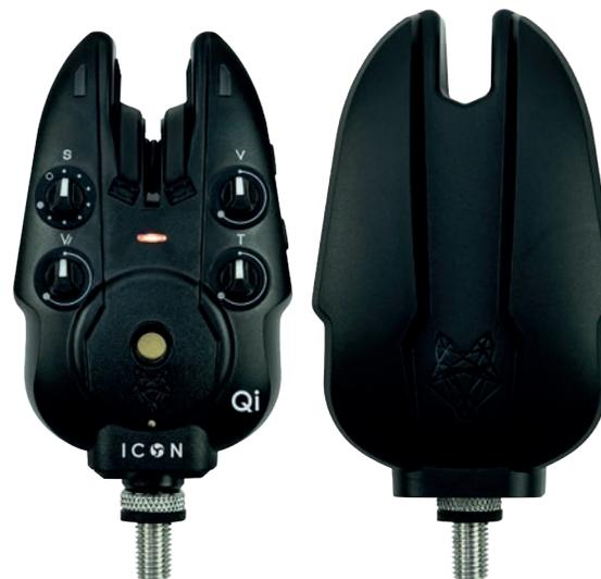
Pour mettre le détecteur de touche sous tension, retirez l'étui rigide et assurez-vous que le bouton de sensibilité n'est pas en position Off. Au démarrage, le niveau de la batterie est indiqué. Pour mettre hors tension le détecteur, replacer le couvercle rigide sur le détecteur ou tourner le bouton de sensibilité sur off. Attendez la tonalité d'arrêt pour confirmer.
