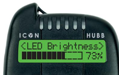
Aller dans "Luminosité LED" pour changer l'intensité lumineuse de la LED sur le détecteur de touche.
