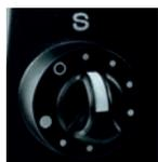
Le bouton de sensibilité ajuste la quantité de course de ligne avant qu'une alerte ne soit déclenchée. Il existe également une position d'arrêt pour désactiver le détecteur. 8 niveaux de sensibilité, extensibles à 16 via le récepteur. 2 mm, 6 mm, 12 mm, 18 mm, 25 mm, 35 mm, 60 mm, 100 mm. \* Paramètres de détection supplémentaires 4 mm, 8 mm, 16 mm, 20 mm, 30 mm, 40 mm, 80 mm et 300 mm.
