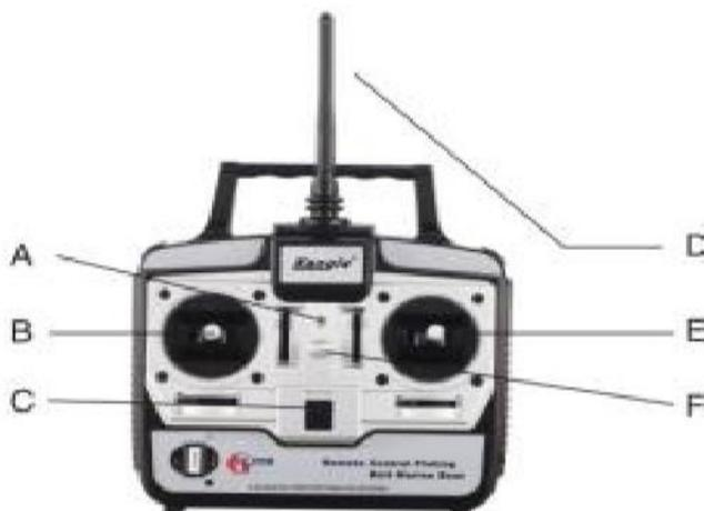
A. Indicadores de potencia. La luz verde encendida significa que el mando a distancia tiene suficiente energía y puede funcionar en su totalidad. Si la luz roja parpadea, significa que hay que hacer volver el barco lo antes posible y cargar el mando a distancia.
