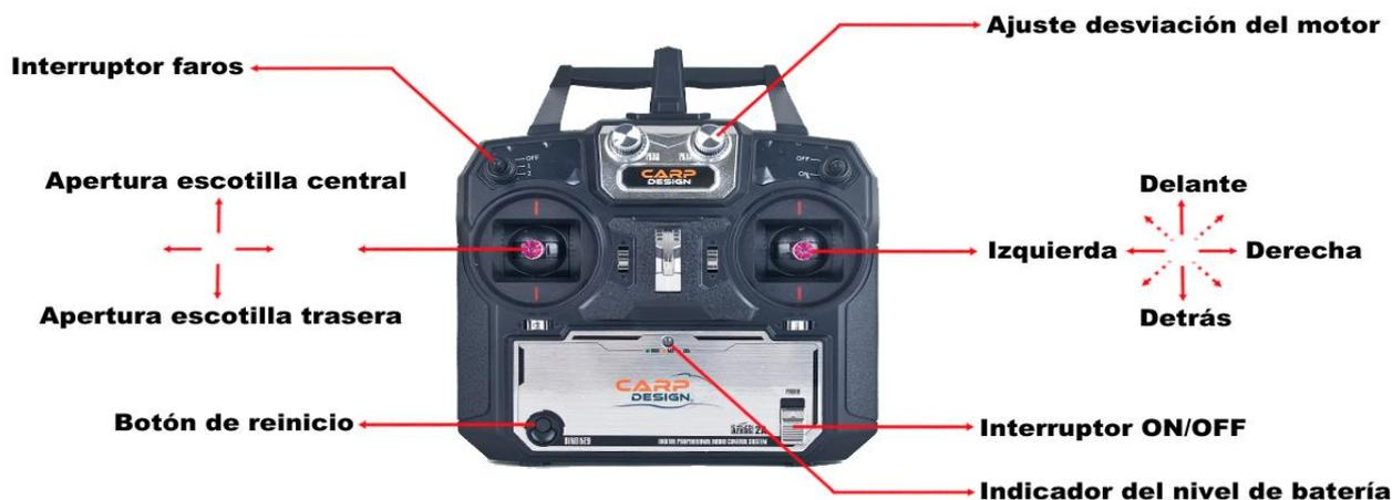
(1) Controla la apertura de las dos escotillas de cebo mediante el cursor situado en la parte izquierda del mando a distancia. Empuje el cursor hacia arriba para abrir la escotilla central y hacia abajo para inclinar la bandeja trasera (donde está su instalación).
